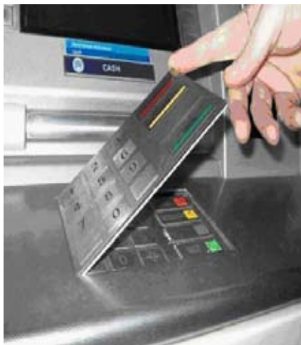
Zdjęcia ilustrują nakładkę na klawiaturę bankomatu służącą do szytywania numerów PIN
